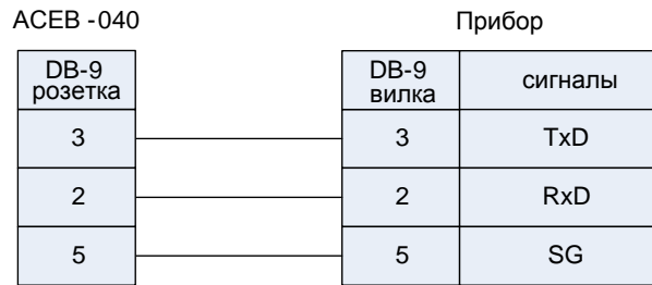
Рис.3. Подключение прибора по интерфейсу RS-232.
